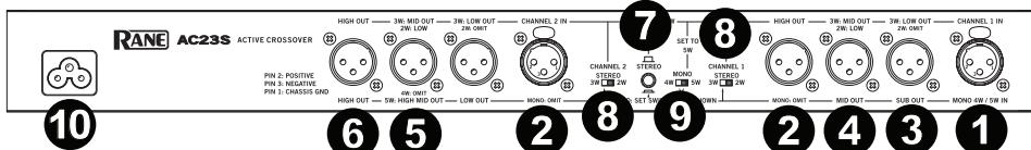
**Subwoofer, graves, medios y altos de izquierda a derecha a lo largo del panel delantero inferior.** Al conectar un cable de conexión desde la salida de agudos del canal 1 a la entrada del canal 2, el rango de crossover de graves/medios cambia de 70 Hz-1 kHz a un rango superior de 190 Hz-7 kHz. Ajuste los controles High Level del canal 1 y Master Level del canal 2 a una ganancia unitaria de "7". Conmute el canal 1 a 3 vías, el canal 2 a 2 vías y ajuste el interruptor mono a 5 vías.
