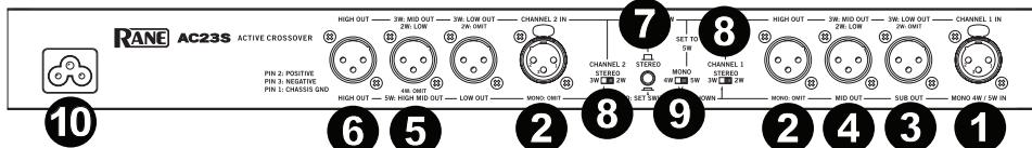
**Sub, bassi, medi e alti da sinistra a destra sul pannello anteriore inferiore.** Collegando un cavo patch dall'uscita High del Canale 1 all'ingresso del Canale 2, l'intervallo dei bassi/medi di crossover passa da 70 Hz-1 kHz a un intervallo superiore di 190 Hz-7 kHz. Impostare il livello alto del Canale 1 e i 2 controlli di livello Master su "7" per il guadagno dell'unità. Far passare il Canale 1 a 3 vie, il Canale 2 a 2 vie e impostare l'interruttore Mono su 5 vie.
