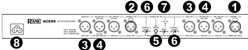
Observe las etiquetas **encima** de las entradas y salidas que aplican para el funcionamiento en estéreo.
