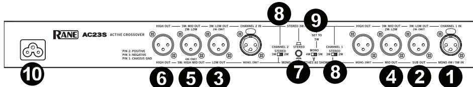
Observe las etiquetas *debajo* de las entradas y salidas que aplican para el funcionamiento en mono.
