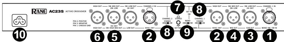
**Sub, Bässe, Mitten & Höhen von links nach rechts über die untere Frontplatte. Durch das Anschließen eines Patchkabels von Kanal 1 Höhenausgang zum Kanal 2 Eingang wechselt der Bass/Mitten Crossover-Bereich von 70 Hz-1 kHz auf einen höheren Bereich von 190 Hz-7 kHz. Setzen Sie den Kanal 1 Höhenpegel und die 2 Master-Pegelregler auf „7“ für die Einsverstärkung. Schalten Sie den Kanal 1 auf 3-Wege, Kanal 2 auf 2-Wege und stellen Sie den Mono-Schalter auf 5-Wege.**
